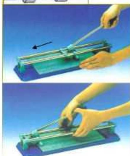
**UTILIZARE:** Inainte de a incepe lucru verificati starea dispozitivului si buna functionare. Asezati dispozitivul pe o suprafata solidă curată și stabila. Potriviti bine placă ceramica, verificati ca rola să calbe exact pe unde doriti să o tajati. Incepeti tajetura de la marginea apasand si impingand manerul de actionare spre celalalt capat al tajeturii.
