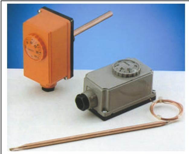
Termostat in imersie cu mod de functionare prin dilatare, intr-o carcasa de protectie din plastic. Acest termostat, in general prevazut pentru conductele de tur, este destinat in particular reglarii cazanelor, pompelor de circulatie si altor aplicatii industriale. Exista de asemenea si in versiunea cu capilar.
